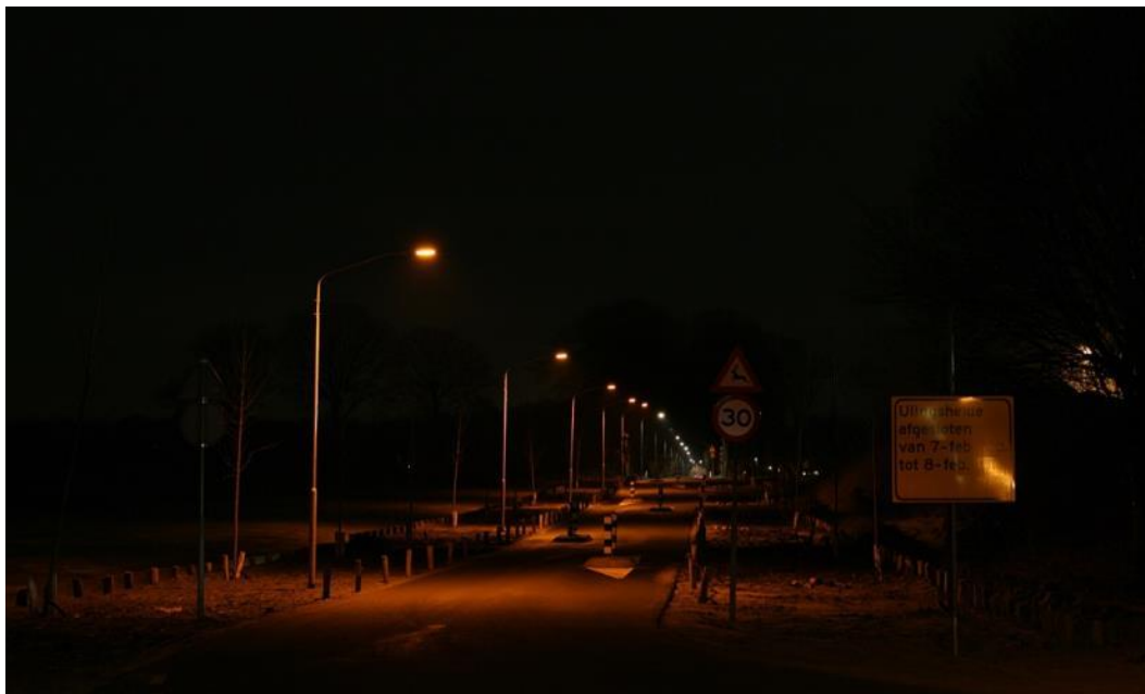
Figura 10 - El alumbrado de color ámbar puede minimizar la perturbación lumínica de la trayectoria de vuelo de un murciélago. Por otra parte, las luces de este camino en los Países Bajos sólo se encienden cuando hay una bicicleta o un peatón en la carretera (Foto V. Loehr).
