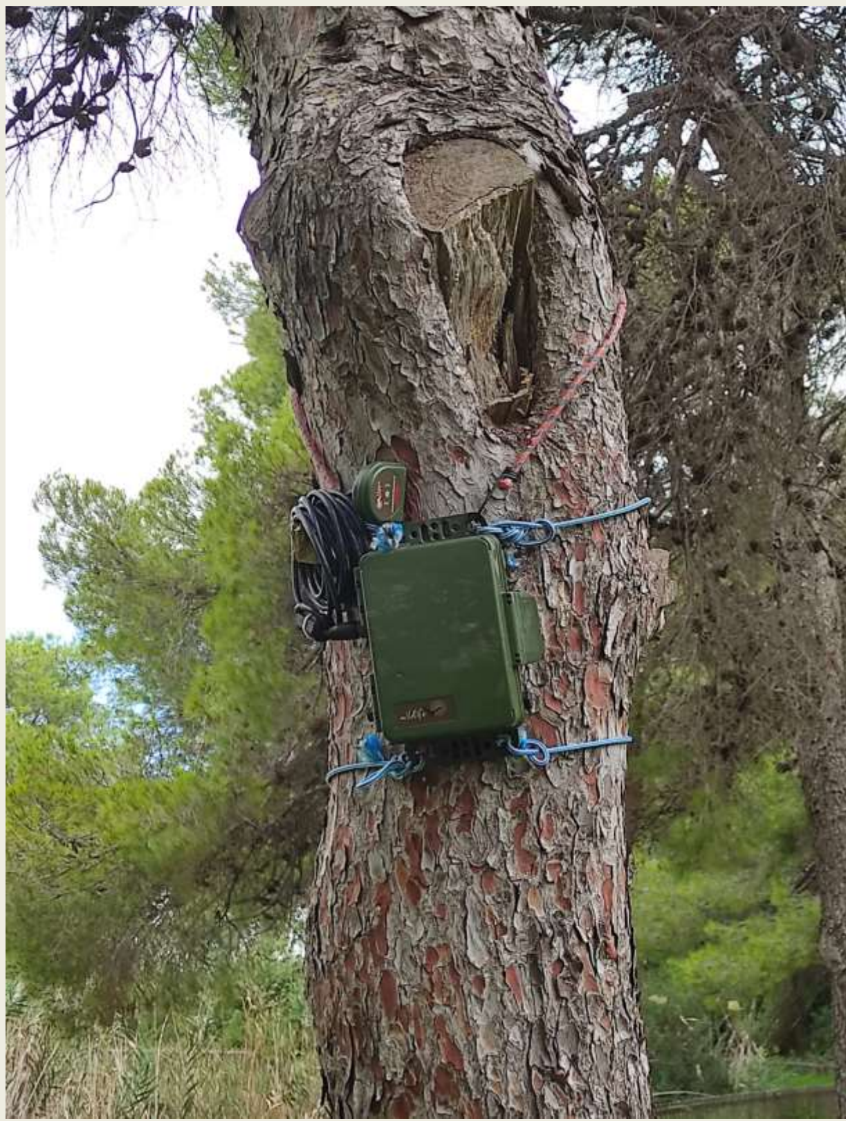
Figura 1. Grabadora de ultrasonidos colocada en uno de los puntos de muestreo del estudio.
