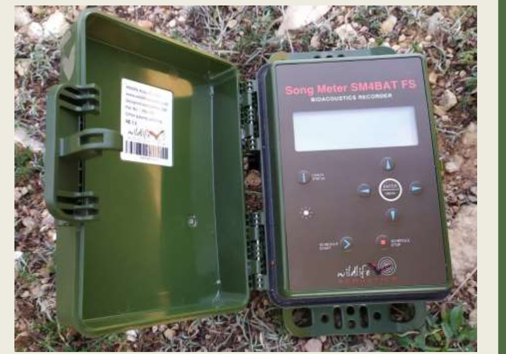
Figura 3. Detalle de la Grabadora Song Meter SM4BAT FS.
